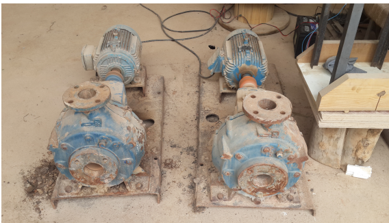
Figura 18 – Bombas usadas para servirem de carga para o motogerador.
