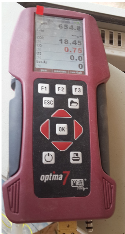
Figura 24 – Analisador da composição dos gases de exaustão.
