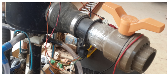
Figura 22 – Sensor de fluxo de ar para medir vazão de ar que entra no motor para combustão.
