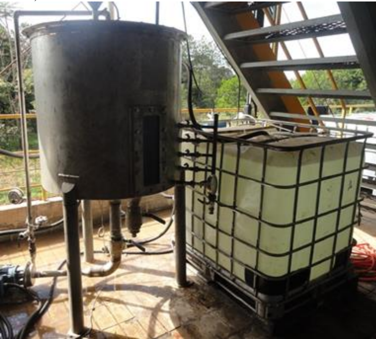
Figura 4.3 - Unidade experimental destinada à produção enzimática de ésteres metílicos de material graxo em planta piloto (empresa Prisma Brazil - divisão ésteres).
