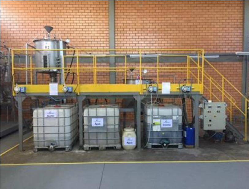
Figura 4.1 - Plataforma metálica com a unidade experimental montada para a produção enzimática de ésteres metílicos de material graxo em planta piloto (empresa Transfertech Gestão e Inovação Ltda).
