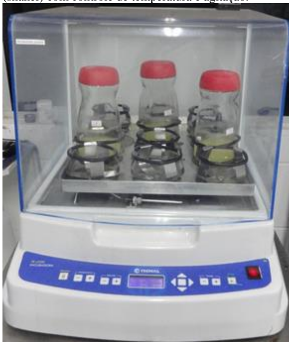
Figura 4.4 - Sistema reacional contendo os frascos de 1,5 L em agitação orbital (shaker) com controle de temperatura e agitação.
