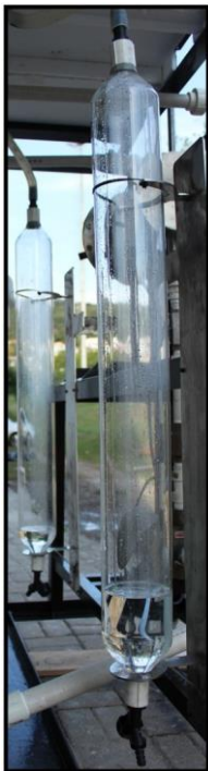
Figura 4.19– Reservatório de água condensada.
