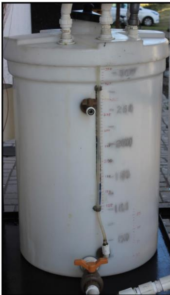
Figura 4.18– Tanque de circulação de água.
