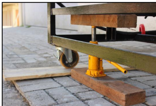
Figura C.1– Posicionamento e nivelamento da bancada experimental.
