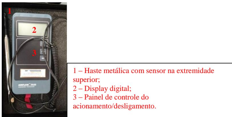
De acordo com o fabricante, podem-se assumir os intervalos de medição e as incertezas para cada variável mensurada por esse equipamento conforme abaixo:
