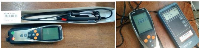
No segundo dia de calibração, a montagem foi repetida (Figura 85), tendo sido substituído o sensor de referência Testo para temperatura do ar pelo sensor de velocidade do ar, da mesma marca. Para o
