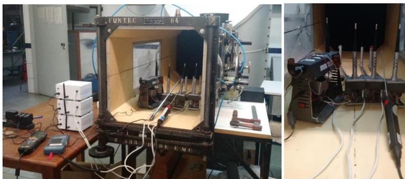
Figura 86 – Sensor Testo (esq.) e a comparação de  $T_{ar}$  entre Testo e AIRFLOW
