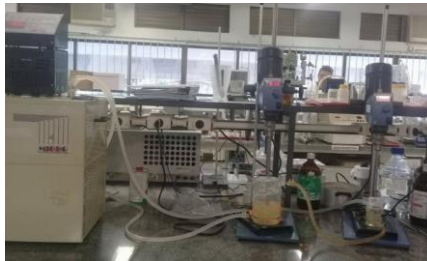
Figura 5: Reator de vidro encamisado com agitação mecânica e banho termostático.
