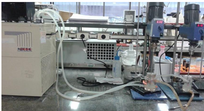
Figura 4 - Reator encamisado com agitação mecânica, acoplado ao banho termostático.
