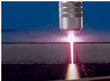
Figura 6 – Equipamento de corte a plasma. Fonte: Processos de soldagem e corte 5
