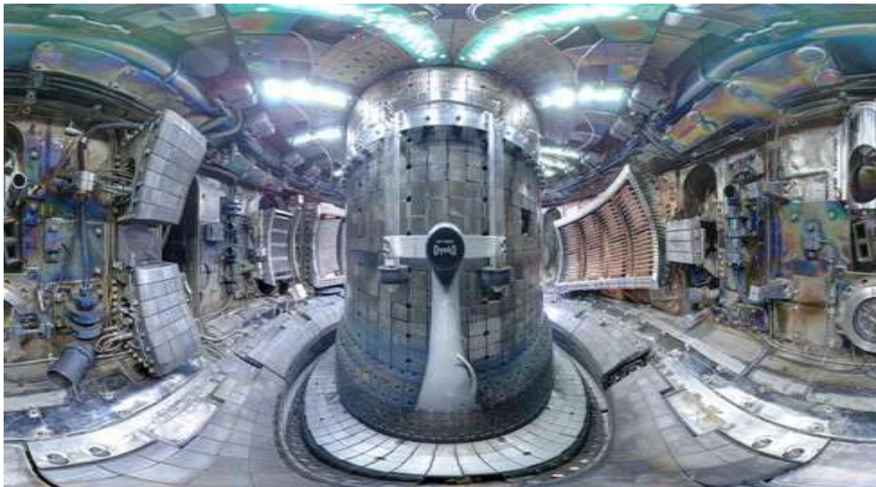
Figura 4 – Fotografia interior do tokamak ALCATOR C-MOD do Instituto de Tecnologia de Massachusetts (MIT) 4 .
