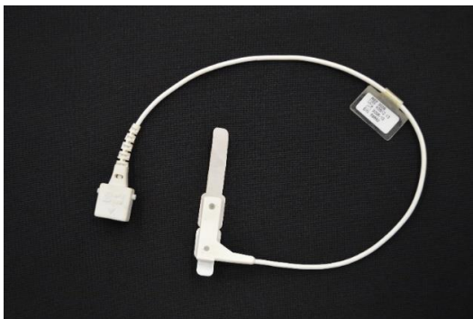
Figura 4. Sensor utilizado para adaptação no dedo óptico do simulador (Modelo 3025, Smiths Medical).
