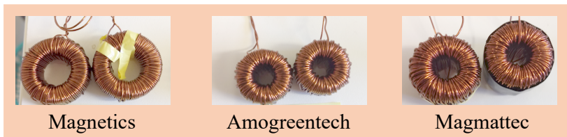
Figura 5.4: Fotografia dos indutores de 1 mH para comparar modelos das três marcas.
