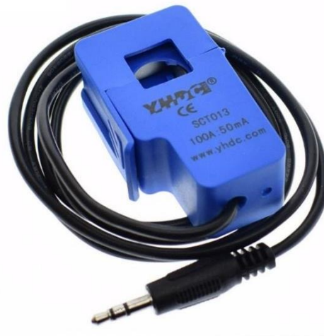
Figura 2 - Transformador de corrente de núcleo bipartido. Fonte: YHDC
