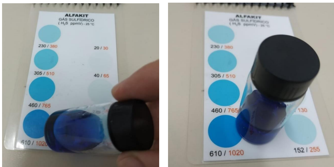
Figura 14 - Análise colorimétrica do gás sulfídrico utilizando 1 mL de biogás.
