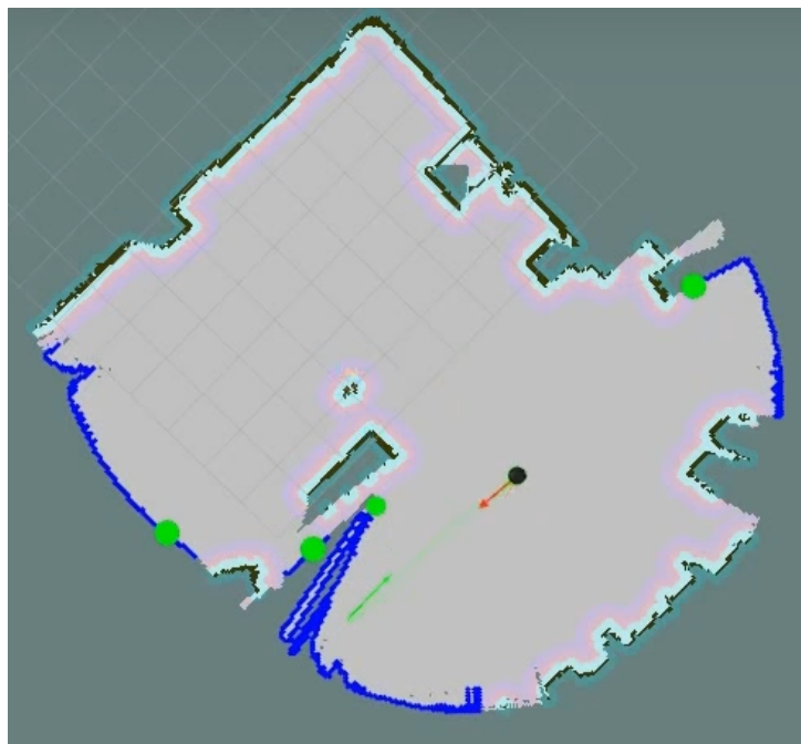
Figura 18 – Resultado do exploratio_lite [Fonte: ROS exploration lite 1 ].
