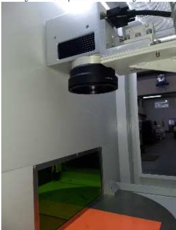
Figura 26 - Cabeçote do laser e área de gravação
