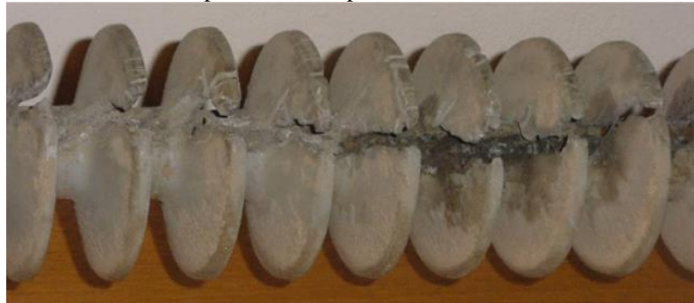
Figura 12: Isolador bastão polimérico em processo de trilhamento bastante avançado.
