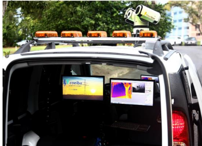
Figura 20: Inspeção de redes de distribuição com termovisor.
