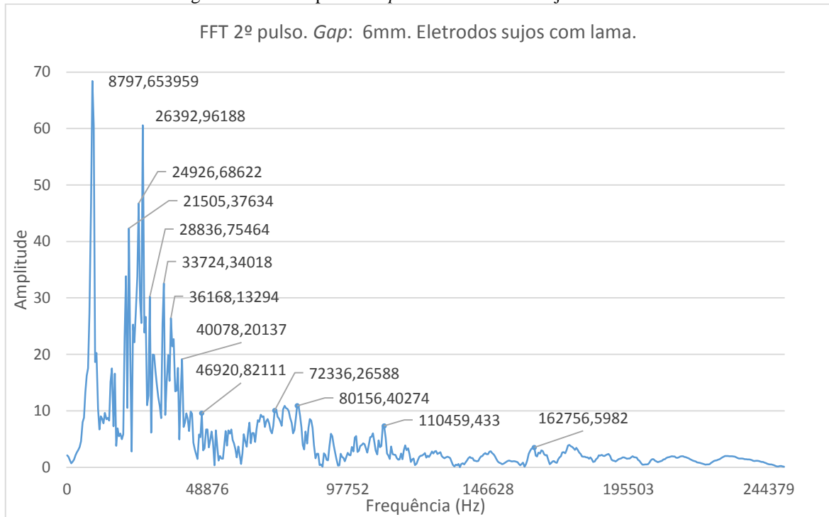
Figura 76: FFT 2º pulso. Gap : 6mm. Eletrodos sujos com lama.
