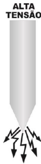
Figura 13: Exemplo de configuração que pode gerar descargas tipo corona.
