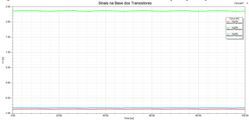
Figura 30 - Sinais simulados na base dos transistores (q1b, q2b e q3b).
