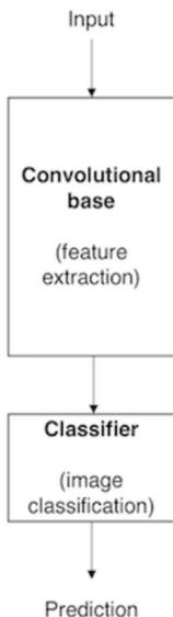
Figura 4.6: Arquitetura básica de uma rede convolucional. Fonte: [30].
