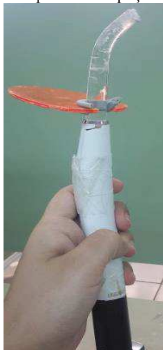
Figura 9 - Fotopolimerizador a. em boas condições, b. com ponteira danificada, protetor e fita adesiva para segurar os componentes a peça de mão.
