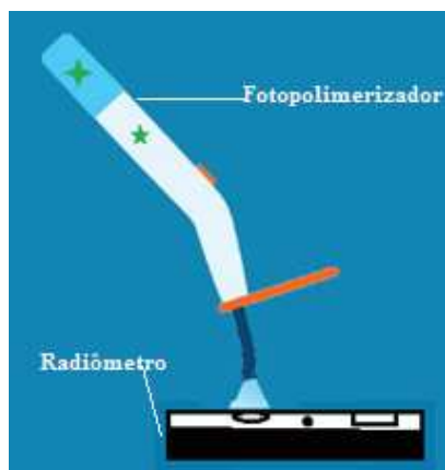
Figura 8 - Posicionamento do condutor de luz do Fotopolimerizador no Radiômetro
