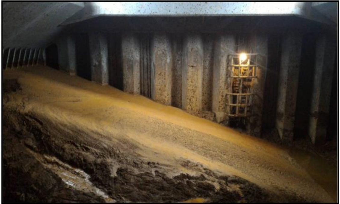
Figura 17 - Carga concentrada em um lado do porão
