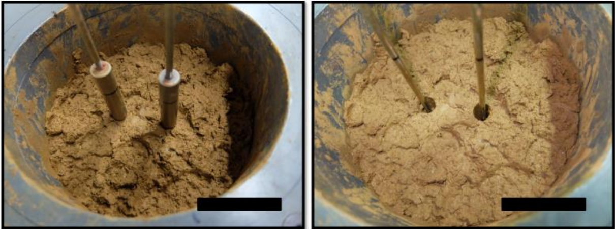
Figura 12 - Exemplo de amostra que sofre liquefação no PT.
