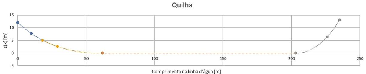
O formato da quilha nas regiões de ré e vante tiveram como base a curvatura do navio *Kaimon Maru*, disponível em Significant Ships of 2013 (2014). Os valores utilizados para a criação da curva são mostrados na Figura 74.
