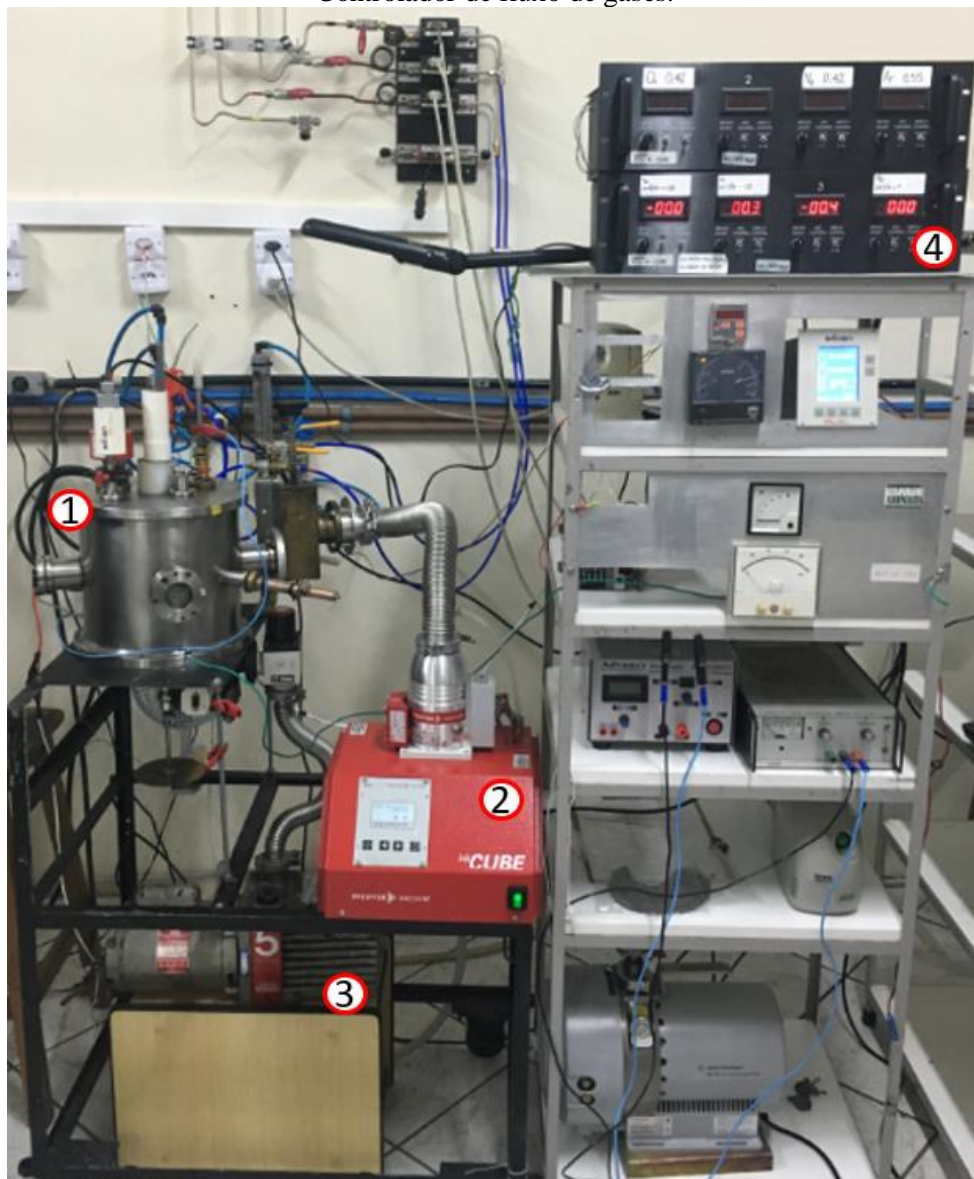
Figura 28 – Conjunto de equipamentos para a deposição por Grid-Assisted Magnetron Sputtering : (1) Câmara de deposição; (2) Bomba de vácuo turbomolecular; (3) Bomba de vácuo mecânica; (4) Controlador de fluxo de gases.
