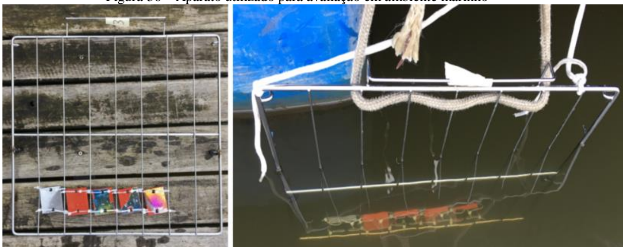
Figura 36 – Aparato utilizado para avaliação em ambiente marinho
