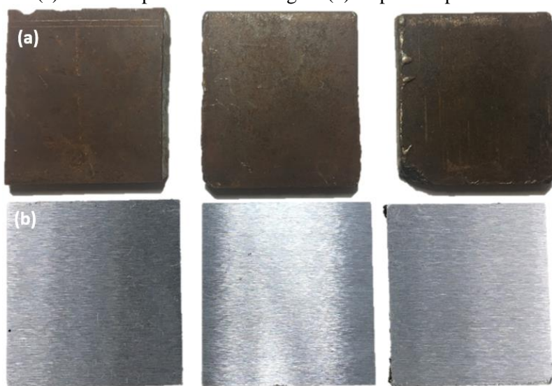
Figura 24 – (a) Antes do processo de usinagem (b) Depois do processo de usinagem.
