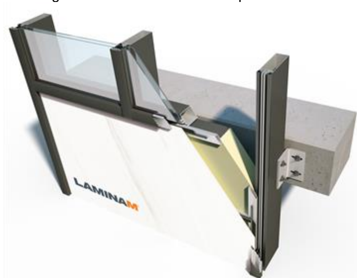
Figura 1 - Fachada cortina em pele de vidro.
