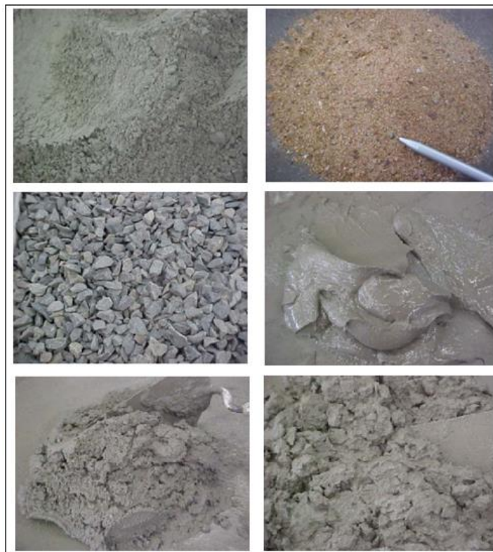
Figura 14 - Componentes do concreto armado
