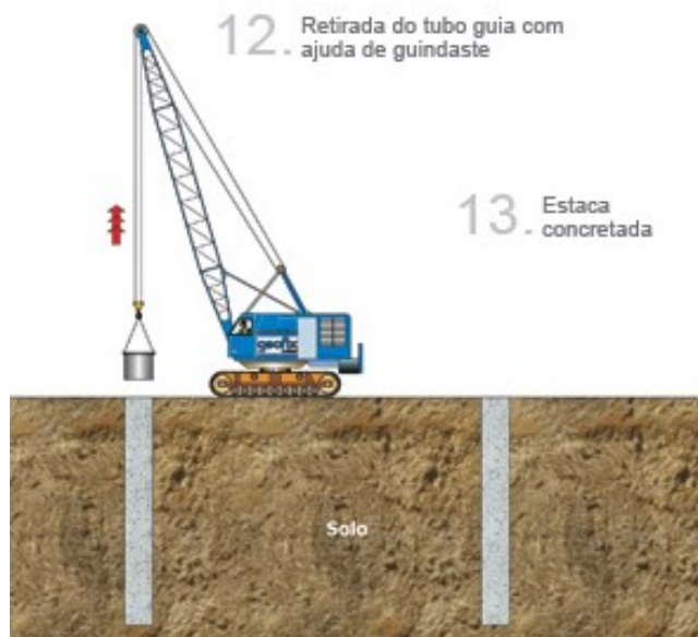
Figura 6 - Execução de uma estaca escavada de grande diâmetro (etapa 12 e 13)
