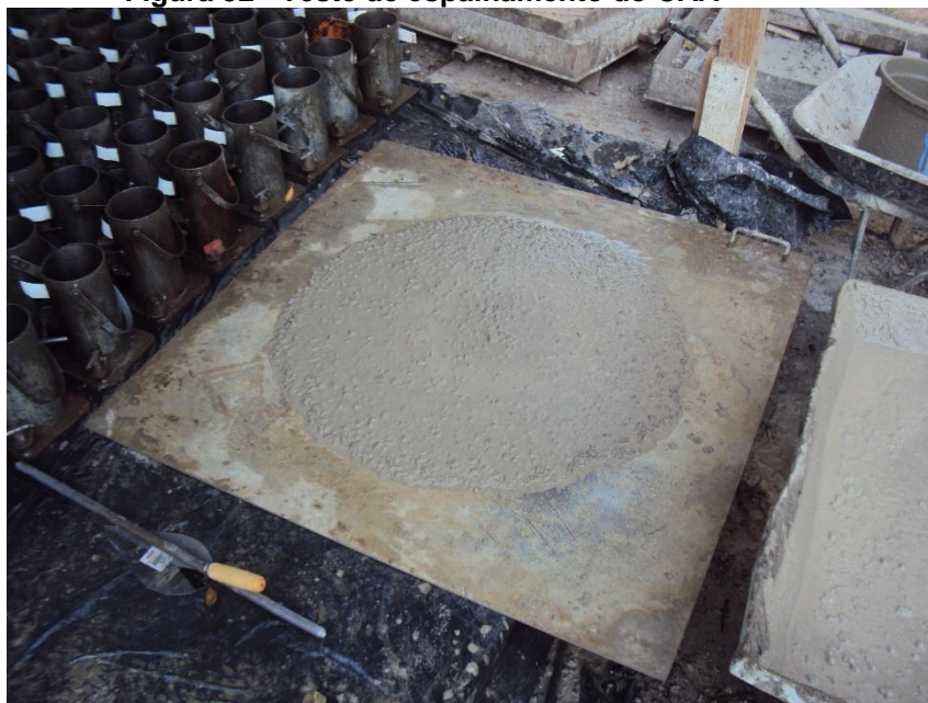
Figura 32 - Teste de espalhamento do CAA
