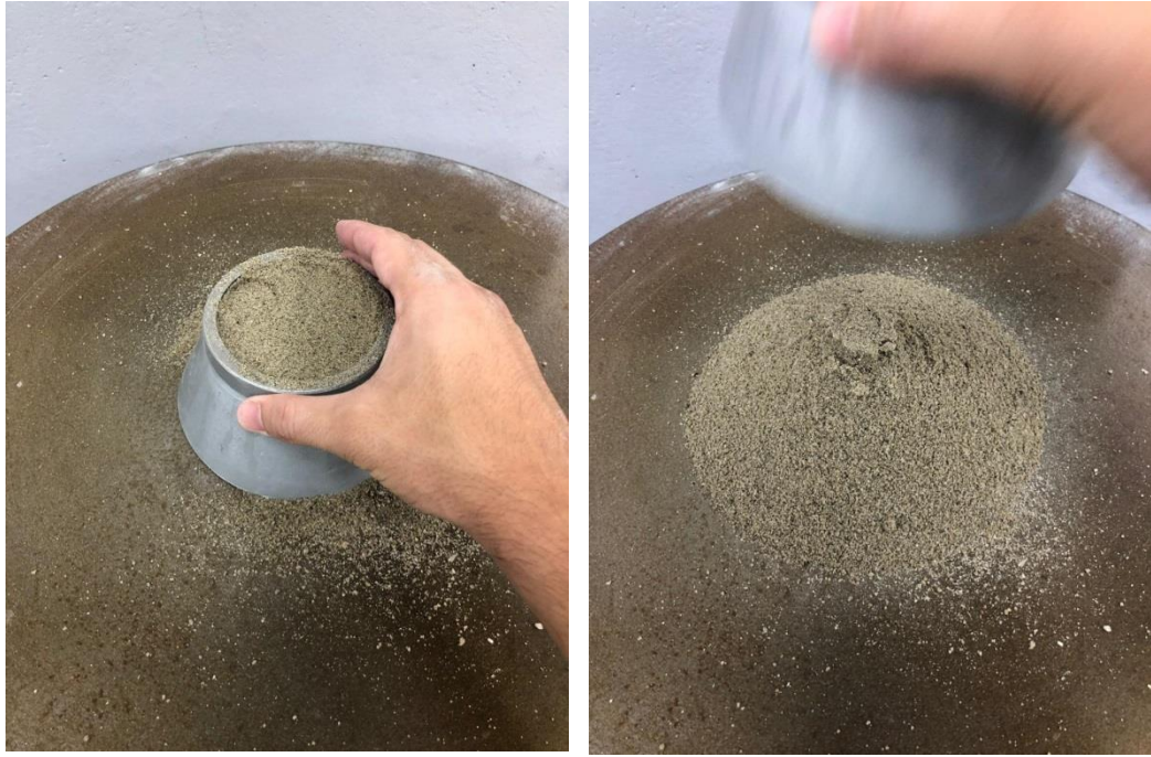
Figura 8 – material saturado com superfície seca após a retirada do molde.
