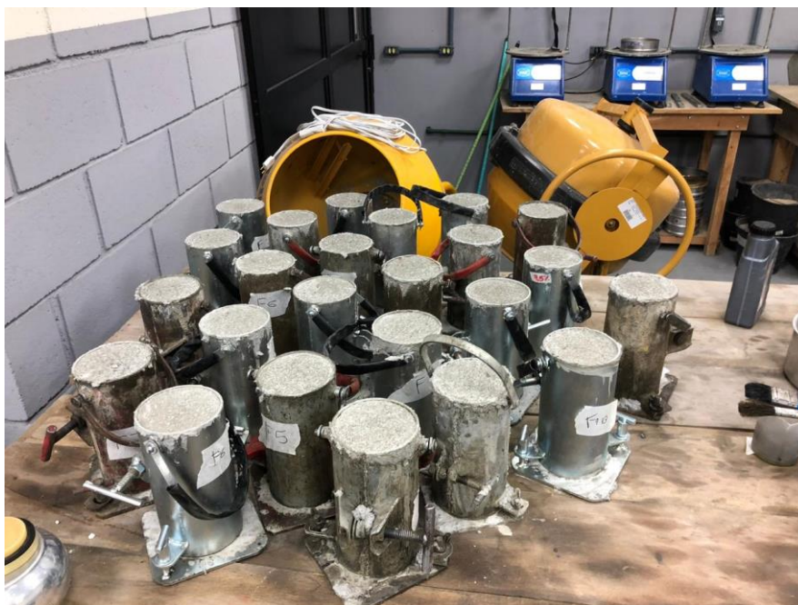
Figura 11 - Moldes de corpo-de-prova após concretagem.
