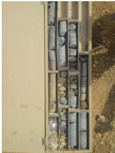
Figura 22: Exemplo de testemunho de sondagem rotativa
