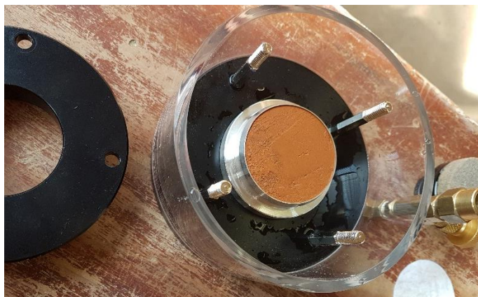
Figura 15- Célula de adensamento com a amostra de rejeito de bauxita
