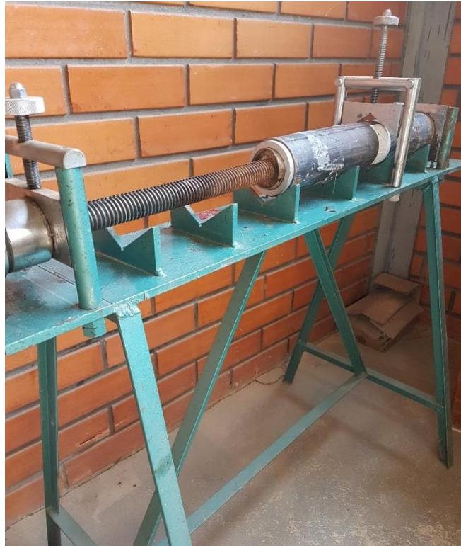
Figura 8 – Extrator utilizado para a retirada da amostra indeformada do amostrador Shelby.
