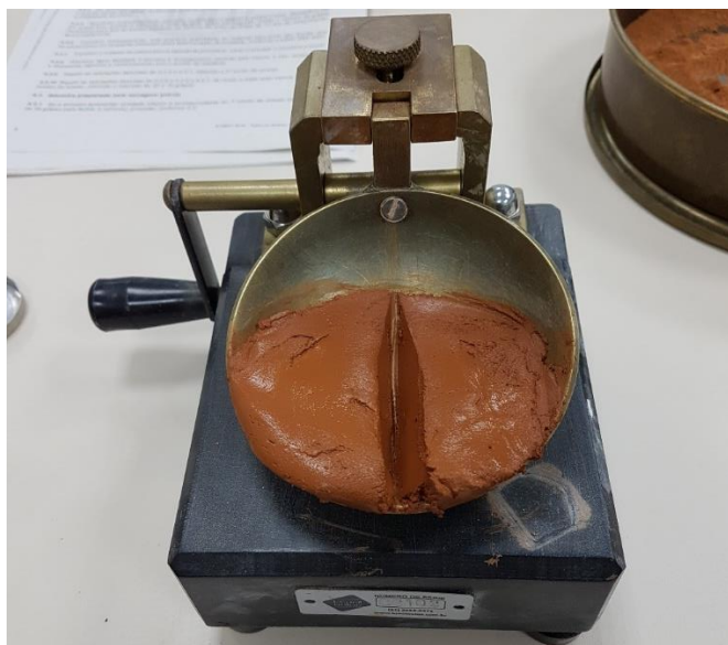
Figura 13 - Aparelho de Casagrande
