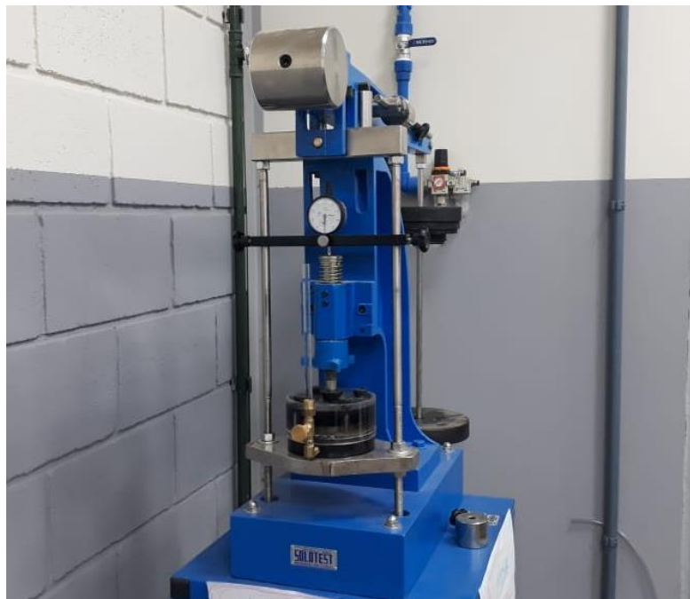
Figura 16 - Prensa de adensamento com leitura de permeabilidade.
