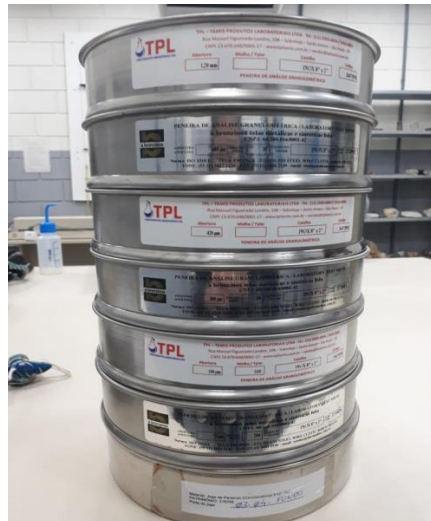
Figura 10 – Sequência de peneiras utilizadas no ensaio de peneiramento fino
