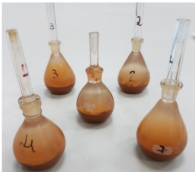
Figura 11 - Picnômetros utilizados na determinação do peso específico real dos grãos
