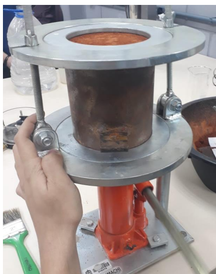
Figura 14 – Extração do material do cilindro de compactação
