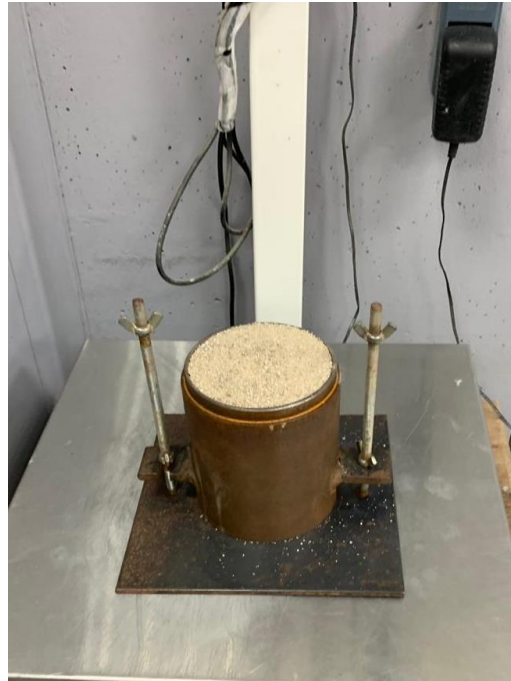
Figura 38. Cilindro de proctor preenchido com areia fina.
