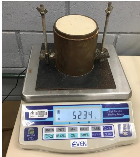
Figura 37. Cilindro preenchido, determinação do índice de vazios máximo.
