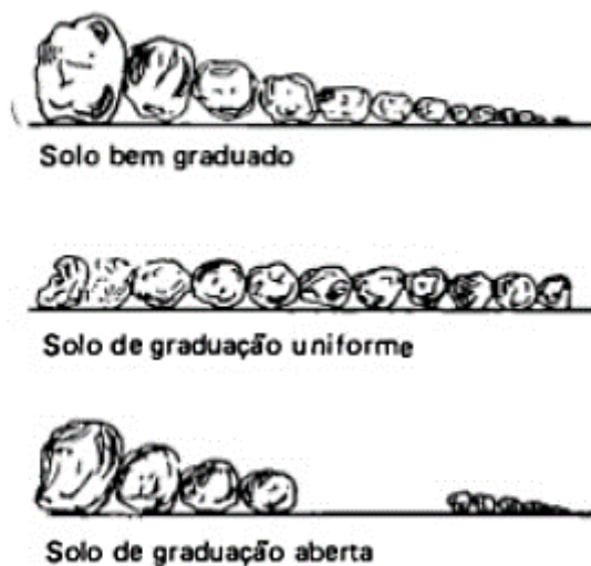
Figura 5. Granulometria de solos granulares
