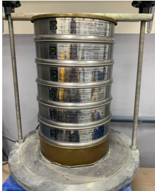
Figura 34. Conjunto formado para peneiramento fino.
