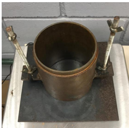
Figura 32. Cilindro de proctor usado nos ensaios de índice de vazios.
