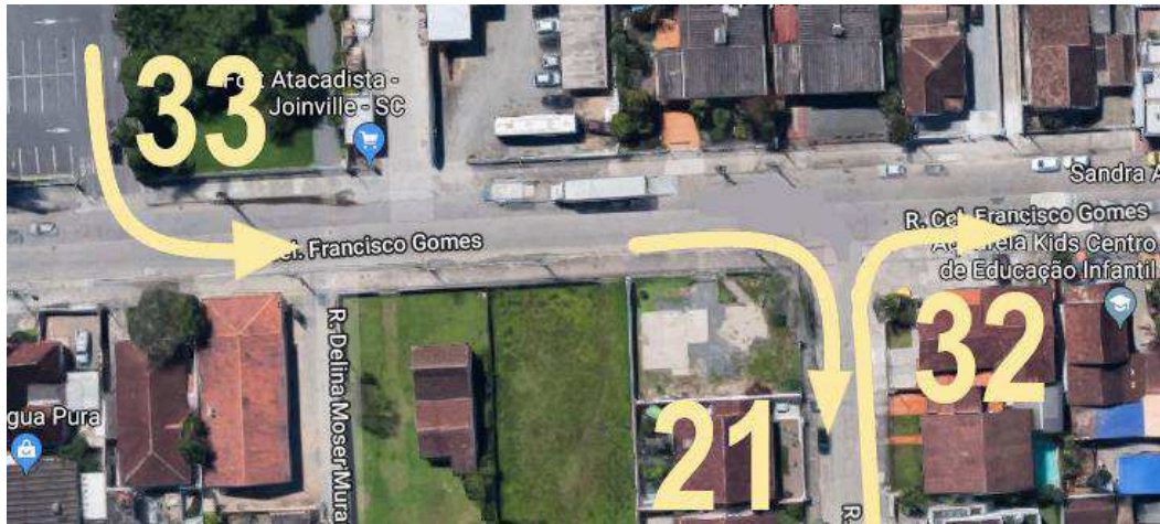
Figura 33 - Indicação dos movimentos 21, 32 e 33 da contagem dos veículos.
