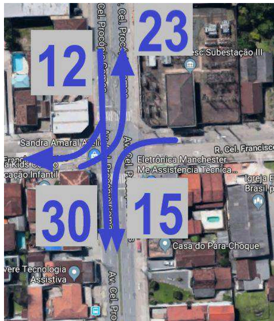
Figura 37 - Indicação dos movimentos 12, 15, 23 e 30 da contagem dos veículos.
