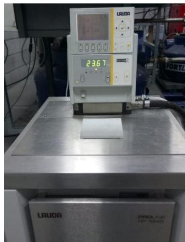
Figura 15 – Fonte de calor Lauda 3.5 kW
