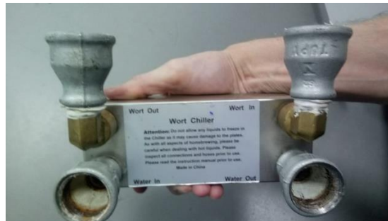
Figura 21 - Trocador PHE usado nos experimentos
