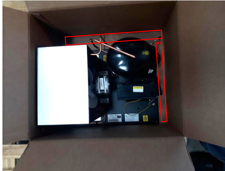
Figura 29 - Teste físico da unidade dentro da caixa proposta.
