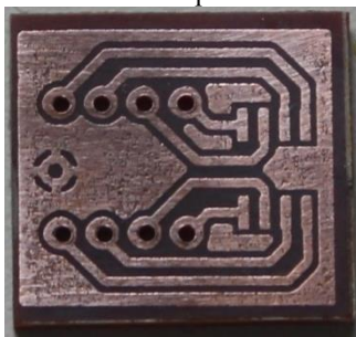
Figura 20 – Placa adaptadora confeccionada antes da soldagem do componente e barra pinos
