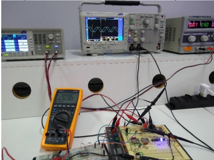
Figura 27 – Medidas emulando sistema bastante inductivo
