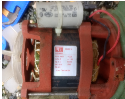
Figura 3.47 – Placa de identificação do motor da motobomba.
