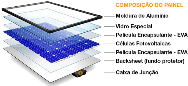
Figura 3.16 – Características construtiva dos módulos PV.
