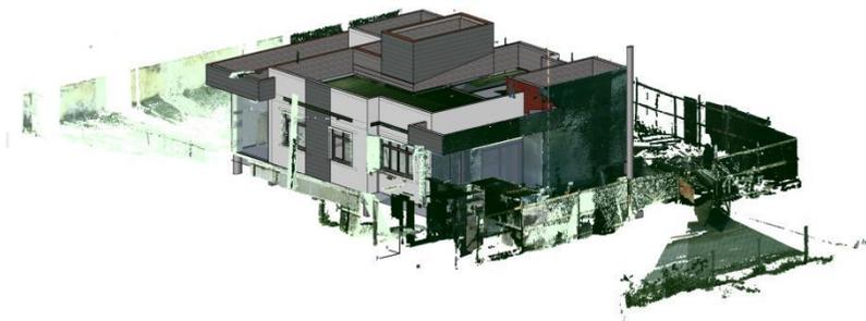
Figura 57: Nuvem de pontos sobreposta ao modelo 3D BIM
