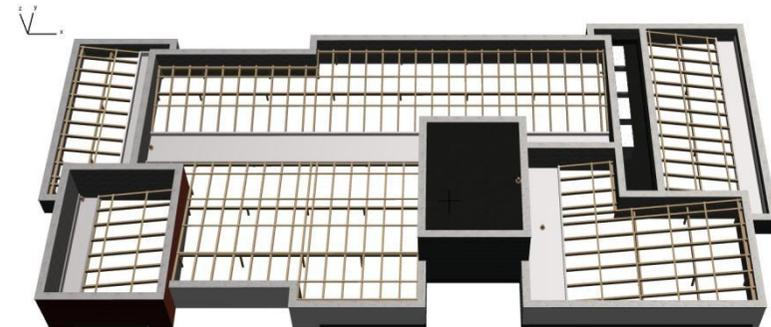
Figura 54: Modelagem do madeiramento do telhado
