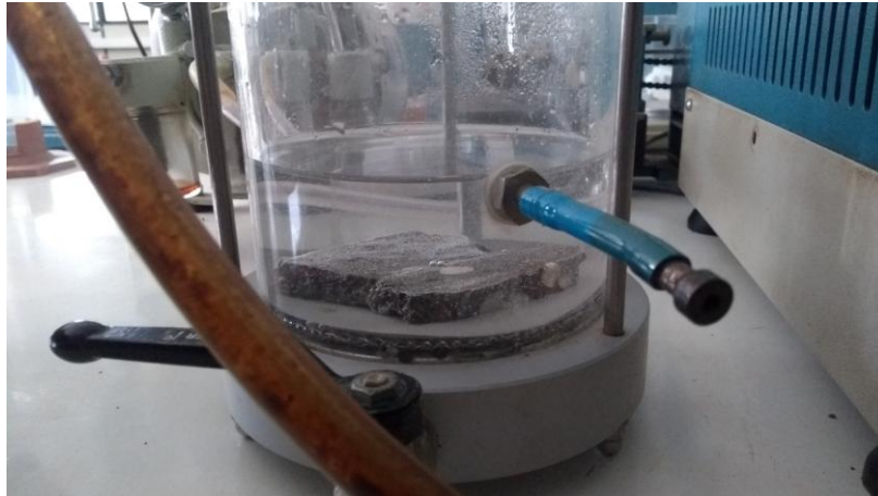
Figura 28. Corpo de Prova 2 imerso em meio aquoso e submetido à pressão negativa da Bomba de Vácuo. Foto: FLABOREA, 2017.
