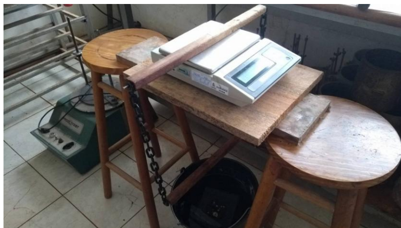
Figura 27. Pesagem do Corpo de Prova em condição submersa. Foto: FLABOREA, 2017.
