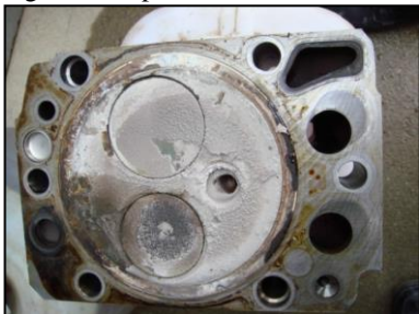
Figura 7: Depósito de sílica nas turbinas e motores II.
