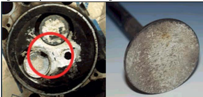
Figura 8: Depósito em válvulas do gerador.
