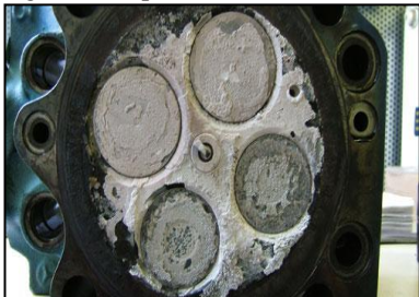
Figura 6: Depósito de sílica nas turbinas e motores I.
