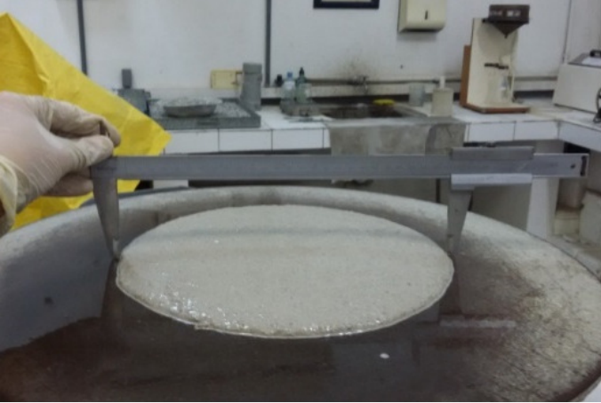
Figura 16: Ensaio de flowtable em argamassa (1:4) com 30% de microfibras.
