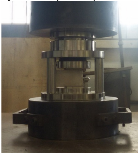
Figura 9: Amostra posicionada para ensaio de compressão
