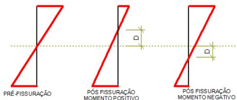
Figura 12-16 – Deformação da seção transversal da laje após fissuração
