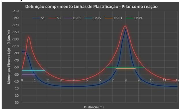
Gráfico 9-1 – Definição Comprimento das LPs – Caso 2 – Seção S1/S3 – Pilar como reação
