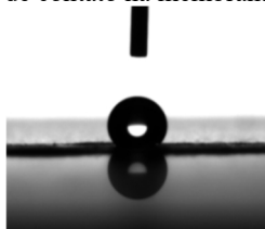
Figura 27 - Teste de ângulo de contato na membrana eletrofiada de PLGA puro.
