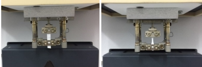
Figura 16 - Equipamento NETZSCH DMA 242E durante o ensaio DMA.
