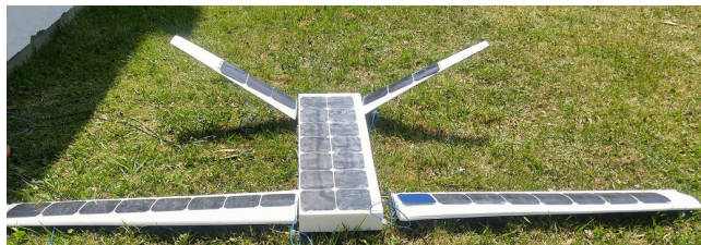
Figura 53 – Estrutura utilizada no experimento do arranjo fotovoltaico
