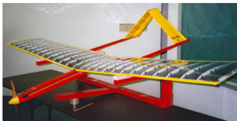
Figura 35 – Células fotovoltaicas no interior de uma asa da aeronave Helios-OSU. Fonte: OSU (2017) .
