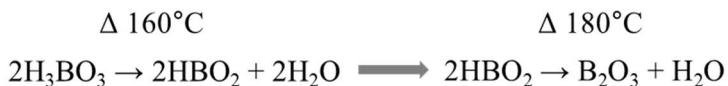
Figura 8 - Reações de transformação de ácido bórico em óxido de boro e água com a temperatura.
