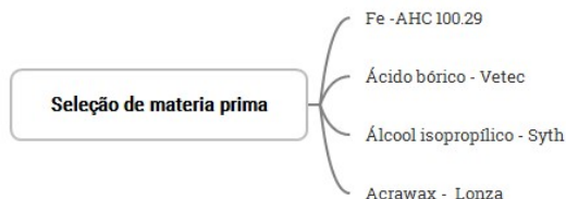
Figura 10 - Matérias primas utilizadas no desenvolvimento de recobrimento com óxido de boro.
