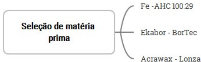
Figura 14 - Matérias primas utilizadas para desenvolvimento de revestimento isolante de boreto de ferro.
