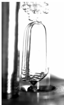
Figura 3.8 – Escoamento na saída do condensador com sub-resfriamento de 3^{\circ}\text{C} (Boeng, 2012)
