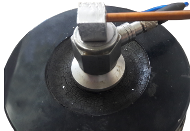
Figura 32 – Montagem do tubo de descarga no shaker utilizando a fixação especial.
