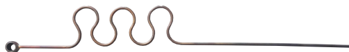
Figura 54 – Filtro geométrico composto por 3 células periódicas com \Theta_y \approx 125^\circ e R = 12 mm por célula.
