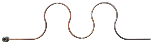
Figura 51 – Filtro geométrico composto por 2 células periódicas com \Theta_y \approx 120^\circ e R = 27 mm por quarto de célula periódica.
