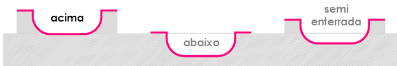
Figura 38- Nível de aterramento das pistas
