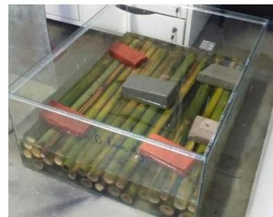
Após 3 dias, os bambus foram retirados da estação de tratamento e colocados para secar em local seco e arejado por 2 meses.
