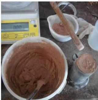
Preparo da mistura para o corpo de prova em calfitice
