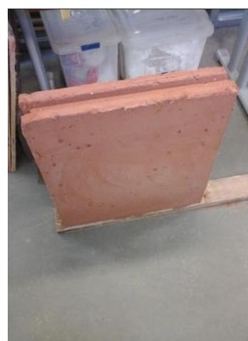
O painel tem um acabamento suave em ambos os lados, com algumas imperfeições quanto pequenas bolhas de ar que são atribuídas à dificuldade foi a compactação das camadas de argamassa no molde durante a fabricação. No entanto, a principal observação é que o peso do painel em relação as suas dimensões, torna difícil o manuseio.
