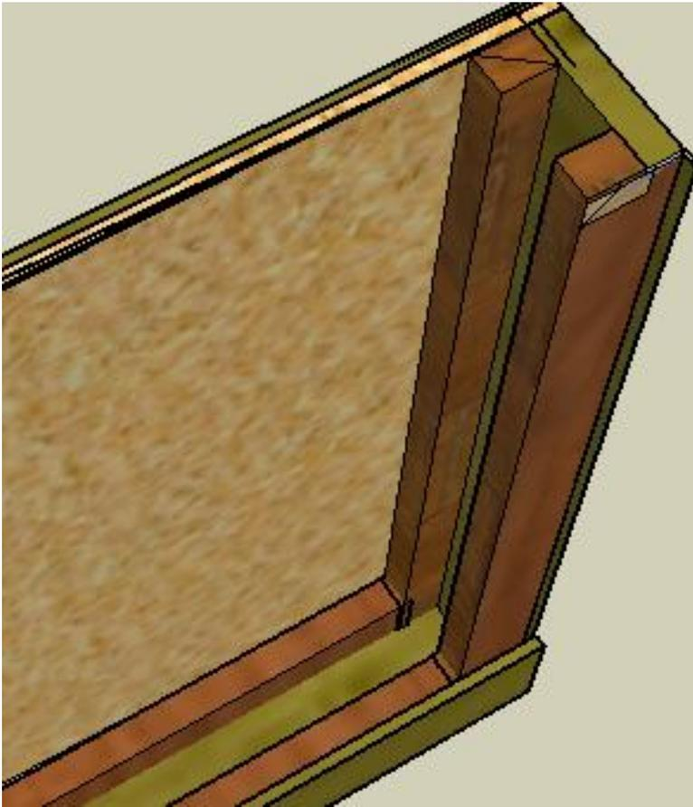
O painel pronto e desenformado, com os encaixes, resultaria na figura abaixo, sendo possível agrupá-los entre si através dos encaixes. Dado o fato da forma ser desmontável, a confecção de vários tipos de painel é possível, como a confecção de um painel que encontra um pilar por exemplo, como ilustra a figura.
