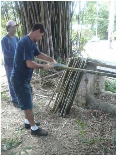
Para colocação no tratamento, após limpeza, primeiramente furaram-se os nós com auxílio de furadeira elétrica. Os furos facilitam a penetração do líquido.
