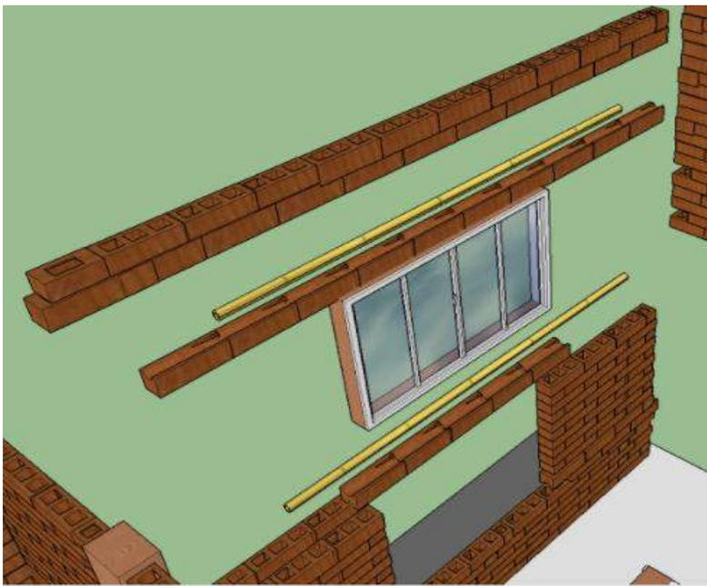
Figura 42: Perspectiva explodida do método verga e contraverga em bambu
