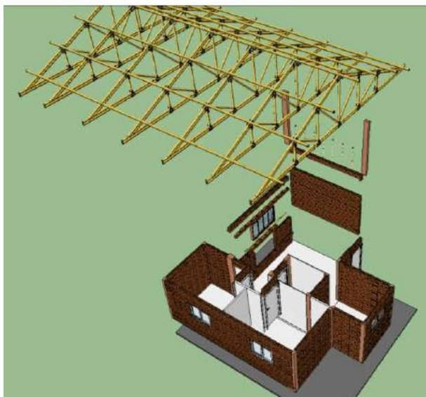
Figura 43: perspectiva explodida do protótipo com treliças de bambu na cobertura
