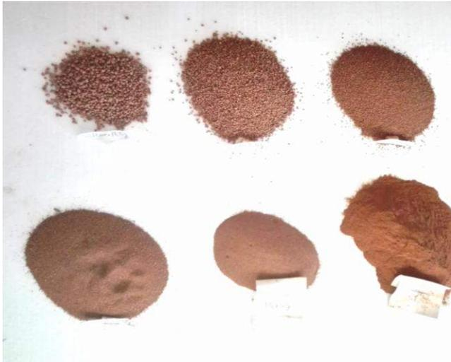
Figura 24: Ensaio de granulometria com peneiras GRANUTEST
