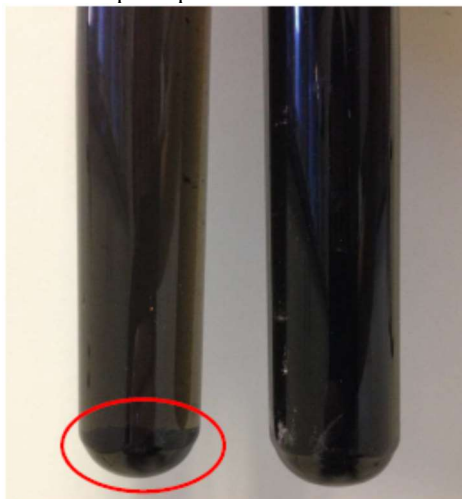
Figura 4.10 – Soluções aquosas de NTC com o aditivo adicionado após a sonicação (esquerda) e antes da sonicação (direita) com energia de 648J/ml e após o período de 24 horas
