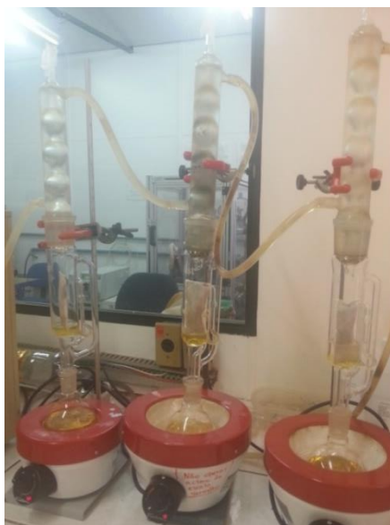
Figura 7 – Equipamento para extração em Soxhlet em funcionamento.
