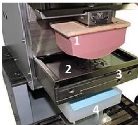
Figura 10 – Máquina de Tampografia: Tampão(1), Clichê(2), Tinteiro(3) e Gabarito(4)
