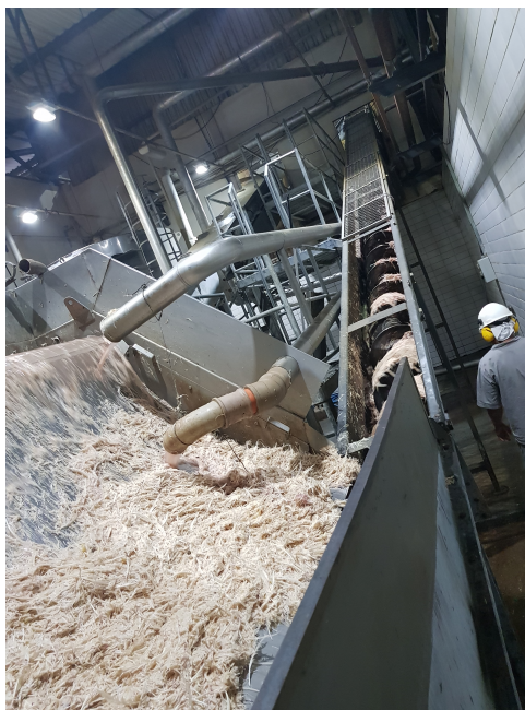
Figura 6 – Peneira para recebimento de penas e rosca transportadora.
