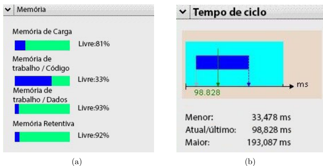
Figura 25 – Resultados obtidos nos testes do CLP. Memória do CLP utilizada (a) e em (b) Tempo de ciclo do CLP.
