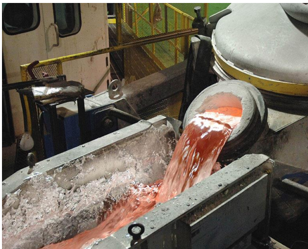
Figura 6 - Transferência de alumínio líquido entre equipamentos. Fonte: Grupo Refraco (2017).
