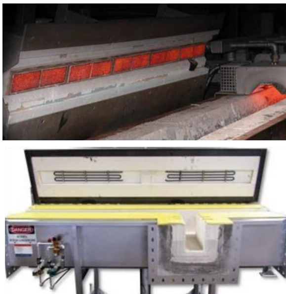
Figura 7 - Exemplo de calha com aquecimento radiativo com queimadores porosos (acima) e com resistências (abaixo).
